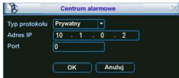
Rys. 5-17. Ustawianie serwera alarmowego.
