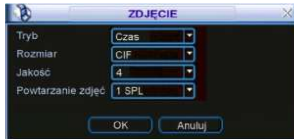
Rys. 4-9b. Ustawianie parametrów zdjęcia w menu Kompresja.
