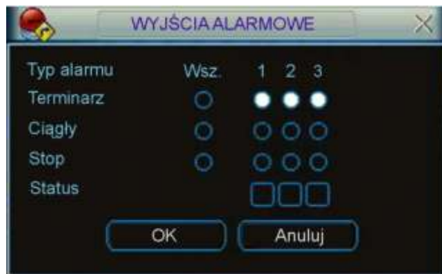
Rys. 5-25. Menu Wyjścia Alarmowe.
