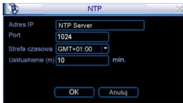
Rys. 5-10. Ustawianie parametrów NTP.
