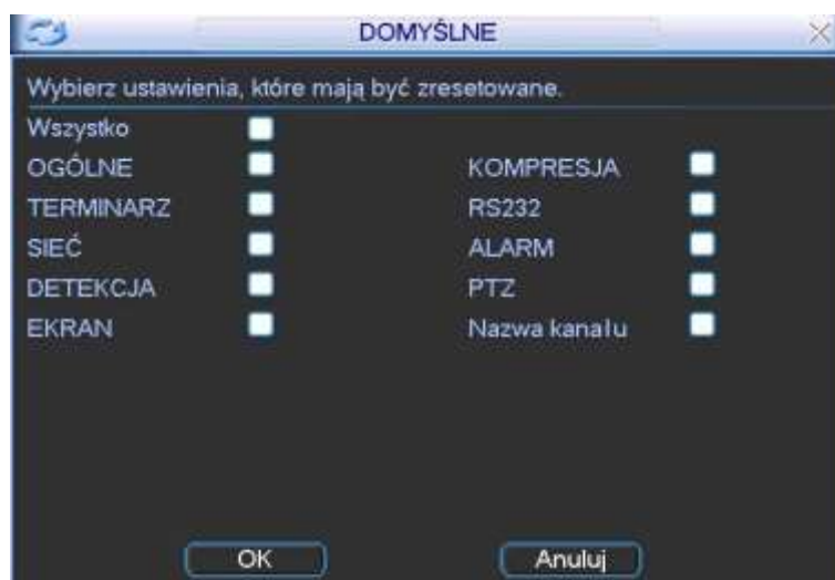
Rys. 5-21. Przywracanie ustawień Domyślnych.
