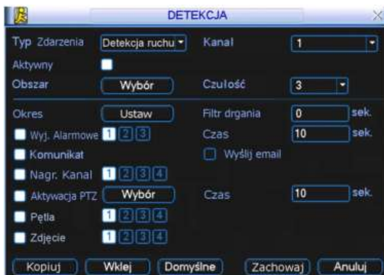
Rys. 4-9d. Ustawianie parametrów zdjęcia w menu Detekcja.
