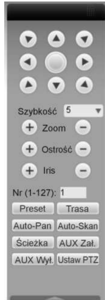
Rys. 7-14. Pełny interfejs sterowania PTZ
