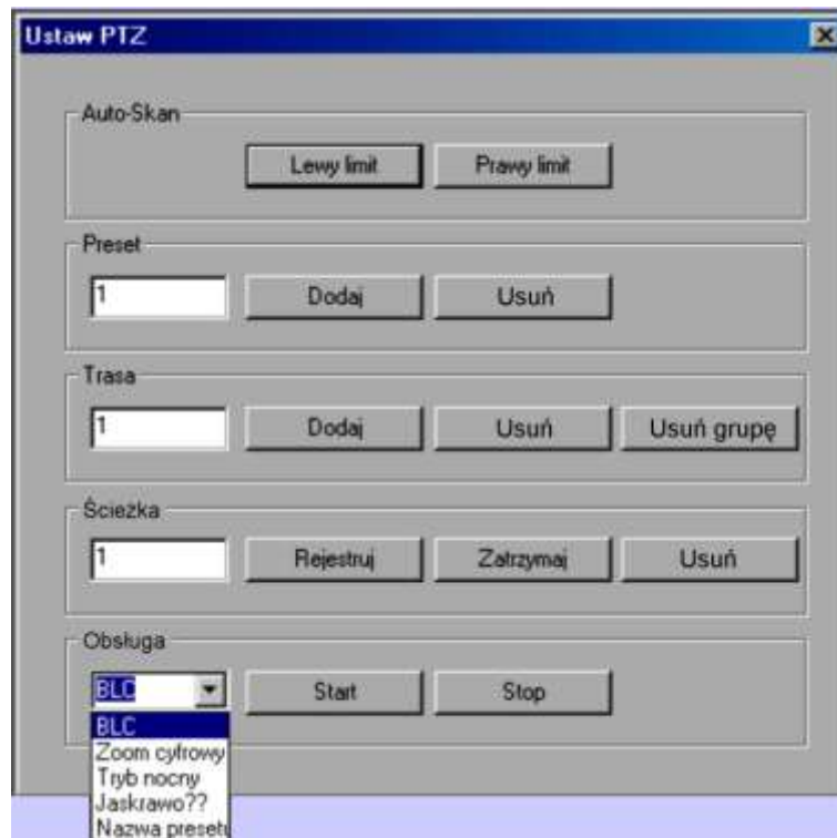
Rys. 7-16. Programowanie parametrów PTZ.
