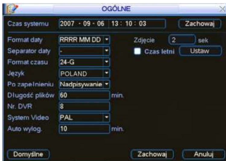
Rys. 4-9c. Ustawianie parametru czas zdjęcia w menu Ogólne.
