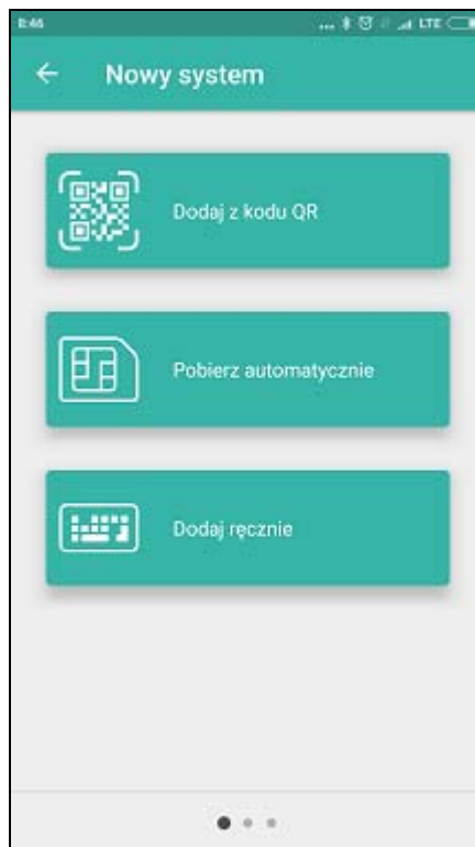
Rys. 44. Aplikacja GX Control (system Android): wybór sposobu konfigurowania ustawień dla nowego modułu.
